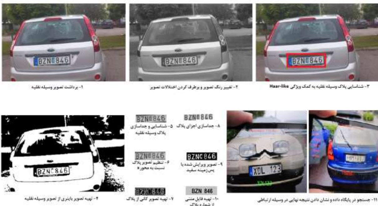
شکل ۷- مراحل سیستم متحرک تشخیص به هنگام پلاک وسایل نقلیه جهت اجر در کشور سوئد [۵]
