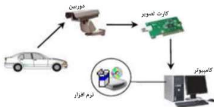
شکل ۴- شمای کلی فرآیند شناسایی پلاک وسایل نقلیه (LPR) [۵]
