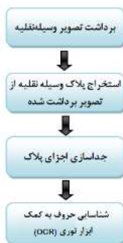
شکل ۵- مراحل سیستم تشخیص پلاک وسیله نقلیه (LPR) [۵]
